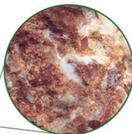
Il Caliche è un deposito roccioso ricchissimo di minerali, iodio e nitrati che viene estratto in enormi quantità nelle regioni di Tarapaca e Antofagasta e lavorato in moderni impianti per l'ottenimento del nitrato potassico.
